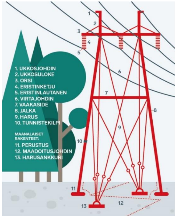
Kuva 1-5. Voimajohdon osat (Fingrid 2021).
