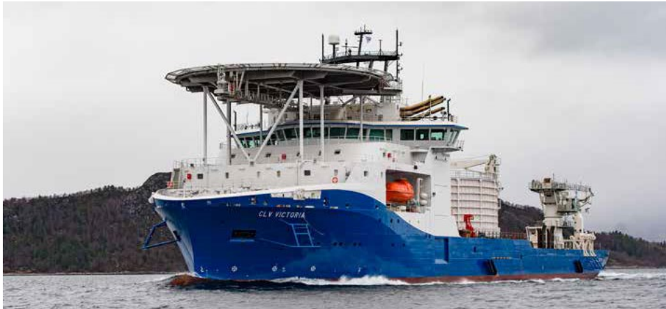
Kuva 1-11. Merikaapeleiden asennusalus (kuva: NKT).
